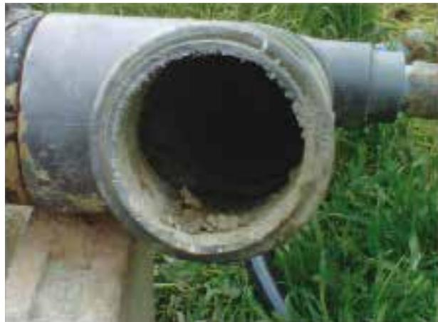
**Figura 2:** Incrustaciones calcáreas y biofilm en tubería de aporte.
